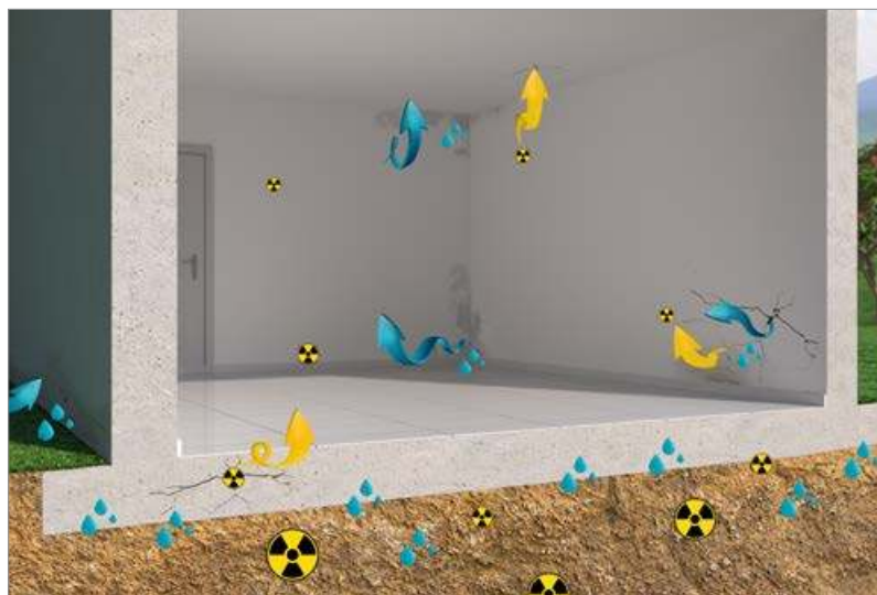
従来型基礎の住宅におけるラドンガスと湿気上昇の危険性
