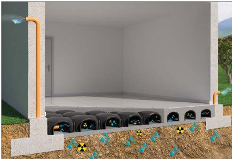
Iglu® 換気基礎で建てられた住宅
